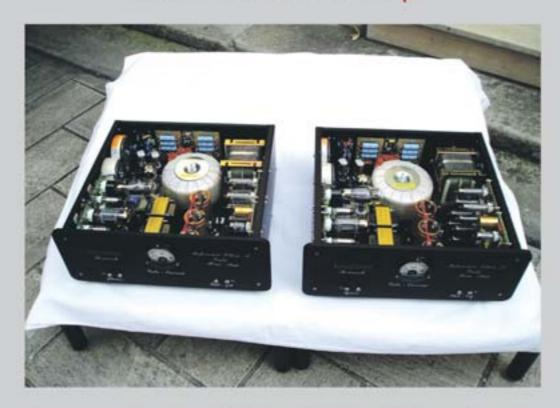
Amplificatori monofonici a valvole cablati in aria con componentistica selezionata e con trasformatori d'uscita costruiti in mu-metal a doppio nucleo 'C'. Funzionamento in classe A
